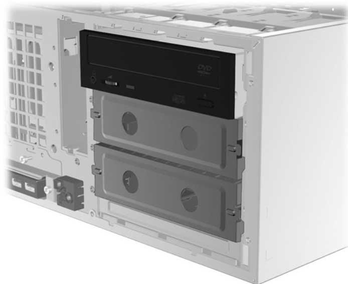
Рисунок 3-9 Установка дисковода оптических дисков на место
